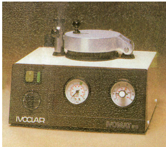
Εικ. 7.5. Συσκευή πολυμερισμού με κενό αέρα (Ivomat)
