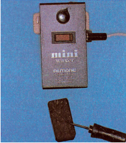
Εικ. 6.4. Κερί χυτών εργασιών κατά τη χρήση του με ηλεκτρική κεριέρα
