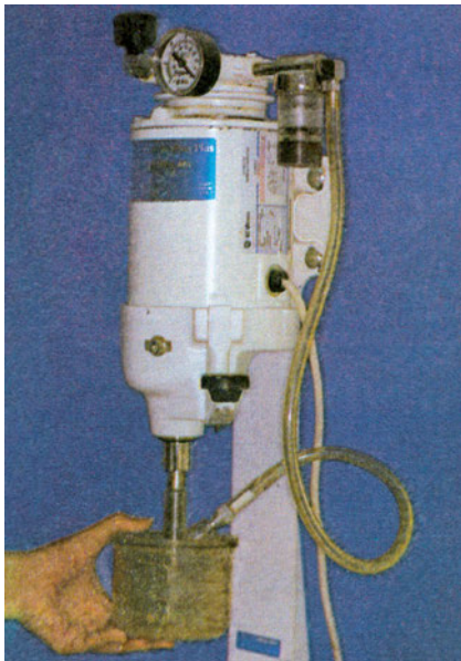
Εικ. 4.7. Συσκευή μηχανικής ανάμιξης σε κενό (Vacuum)
